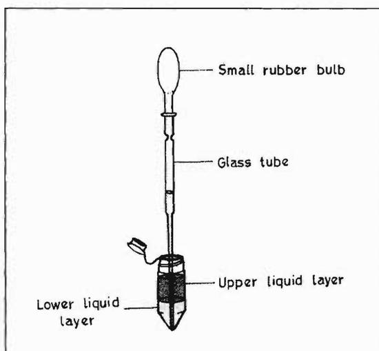
**Figure 2. Use of Pasteur pipettes.**
