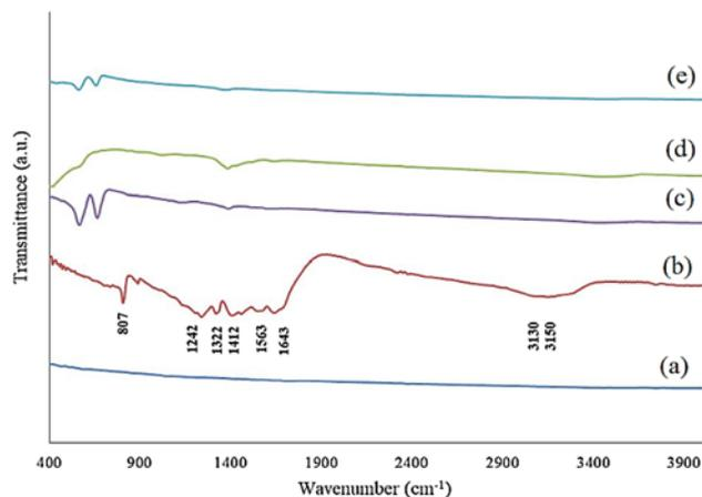
**Figure 2.** FT-IR spectra of (a) rGO, (b) g- $\text{C}_3\text{N}_4$ , (c) Co/g- $\text{C}_3\text{N}_4/\text{rGO}$ , (d) Ni/g- $\text{C}_3\text{N}_4/\text{rGO}$ , (e) Co2Ni1/g- $\text{C}_3\text{N}_4/\text{rGO}$ .
