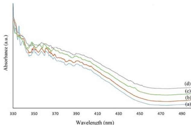
**Figure 3.** DRS spectra of (a) g- $\text{C}_3\text{N}_4$ , (b) Ni/g- $\text{C}_3\text{N}_4/\text{rGO}$ , (c) Co/g- $\text{C}_3\text{N}_4/\text{rGO}$ , (d) Co2Ni1/g- $\text{C}_3\text{N}_4/\text{rGO}$ .
