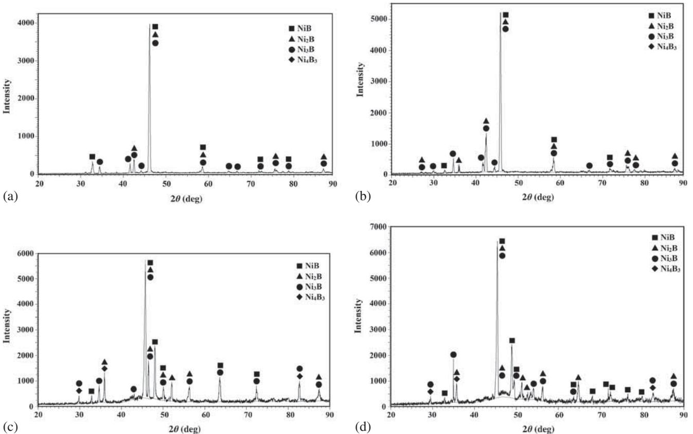
**Figure 3.** X-ray diffraction patterns of borided Nickel 201 alloy (a) 1123 K–2 h, (b) 1123 K–6 h, (c) 1223 K–2 h and (d) 1223 K–6 h.
