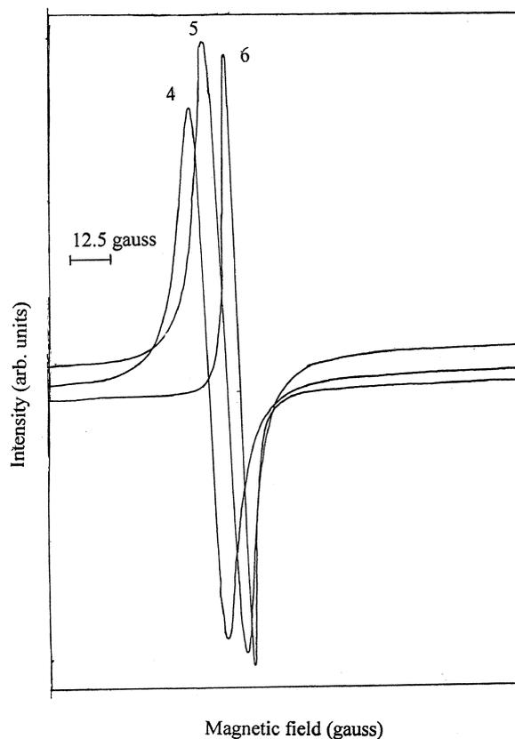
**Figure 2.** EPR spectra of Pani materials: (1) Pani-SO<sub>4</sub><sup>2-</sup>, (2) Pani-SO<sub>4</sub><sup>2-</sup>/TOCr, (3) Pani-SO<sub>4</sub><sup>2-</sup>/TOFe, (4) Pani-SO<sub>4</sub><sup>2-</sup>/TOMn, (5) Pani-SO<sub>4</sub><sup>2-</sup>/TOCo and (6) Pani-SO<sub>4</sub><sup>2-</sup>/TOAl.
